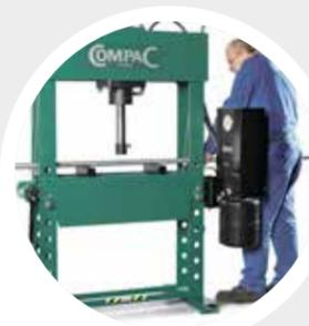
La pompe peut pivoter de 90 degrés et permet l'introduction de pièces de grande longueur.
