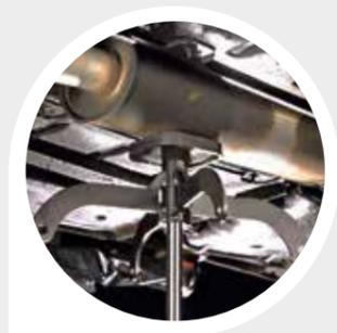
Adaptateur rotatif de boîtes de vitesses avec selle et coussin de caoutchouc.
